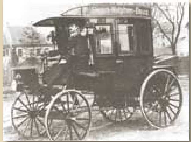
A sinistra il primo tram Daimler del 1888, il cui motore aveva rimpiazzato il cavallo e che portava gli operai alla fabbrica di Cannstadt. Sopra una carrozza del 1895 di Benz , motorizzata omnibus a 8 posti, antenata degli autobus
