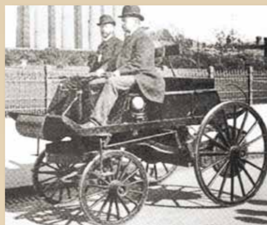
Il primo modello Electrobat pesava in ordine di marcia circa 3 tonnellate. Assomigliava ad un carro funebre per il suo cassone allungato che ospitava le batterie, quelle che i meccanici cambiavano tutte le volte che erano 'morte'.
