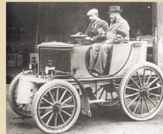
L'aerodinamica di questa Amédée Bollée Fils con una capot sagomata per la corsa, segna la prima tappa nel design automobilistico .
