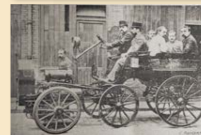
FIG. 303. — Avant-train moteur à pétrole Amiot et Péneau. (Schéma de fabrication.)
