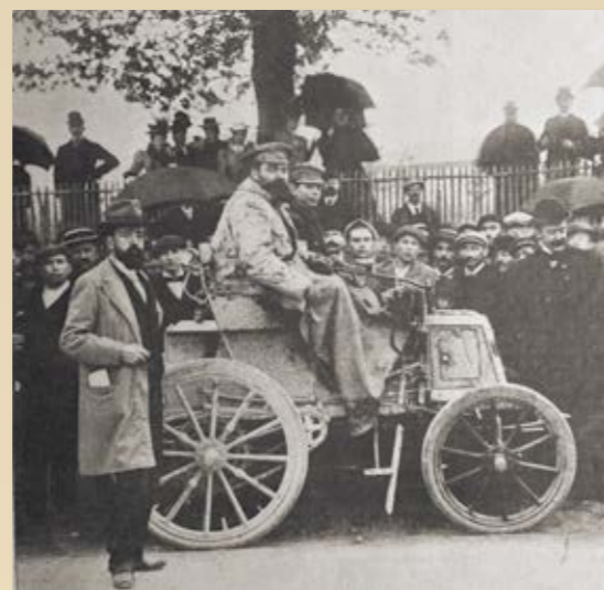
In questa immagine si può notare che, per l'ultima volta in corsa, il vincitore De Knyff guidava una Panhard & Levassor equipaggiata con una barra di direzione o 'queue de vache' (=letteralmente 'coda di mucca') e non ancora con un volante.
